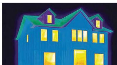
充填断熱材を使った間柱壁だけの外壁(上)と連続断熱材を使った壁(下)との熱損失差は明らかに熱画像でわかります。
