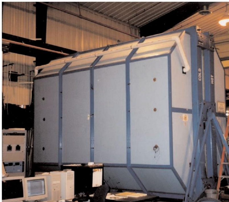
ORNL の全壁試験槽 (ORNL 撮影)
